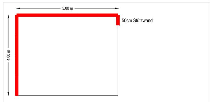
Die Anzahl benötigter Stützwände für Trennwände höher als 2,8 m bzw. für Trennwände mit einer zusätzlichen Wandbelastung durch z.B. Strahler oder Exponate ist individuell mit meplan abzustimmen.
